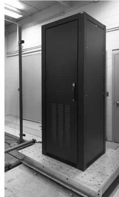
G abinete montado en una mesa vibradora
